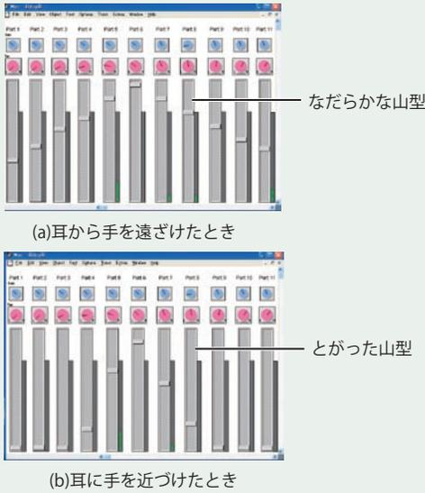
図-12 距離センサの操作による増幅率の変化
