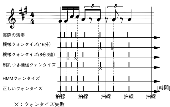
図 9 クオンタイズ結果の例 Fig. 9 An example of quantization results.
