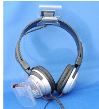
図 8: センサに電子コンパスを用いた試作機
