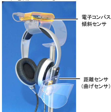
図 1: ヘッドフォンにとりつけた 3 種類のセンサ
