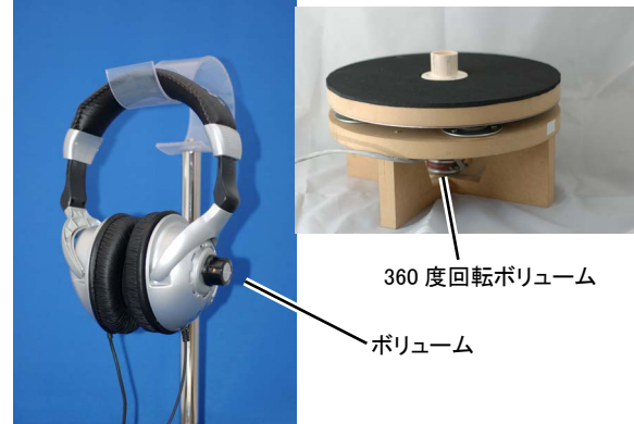
図 7: センサにボリュームを用いた試作機
