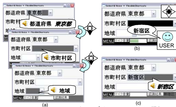
図 1: Select&Voice (a) 上下ボタンで項目を選択, システムは選択された項目名と入力されている値を読み上げる. (b) 発話ボタンを押しながら選択した項目に対し音声入力をする. (c) 認識結果を表示し, 読み上げる.
