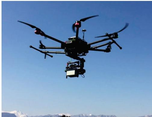
図 2: ドローン(Dji 社 Matrice600)と LiDAR (SICK 社 LD-MRS)
